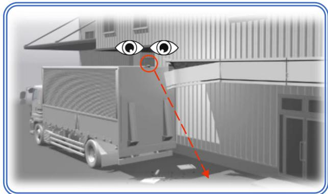
構内事故の原因のひとつとして、通い慣れた構内でバックモニターだけを見て後退したところ、確認不足により構内施設に衝突してしまうケースが考えられます。
